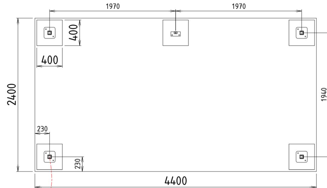
Dimension mini de la dalle béton : 4400 x 2400 x 150
