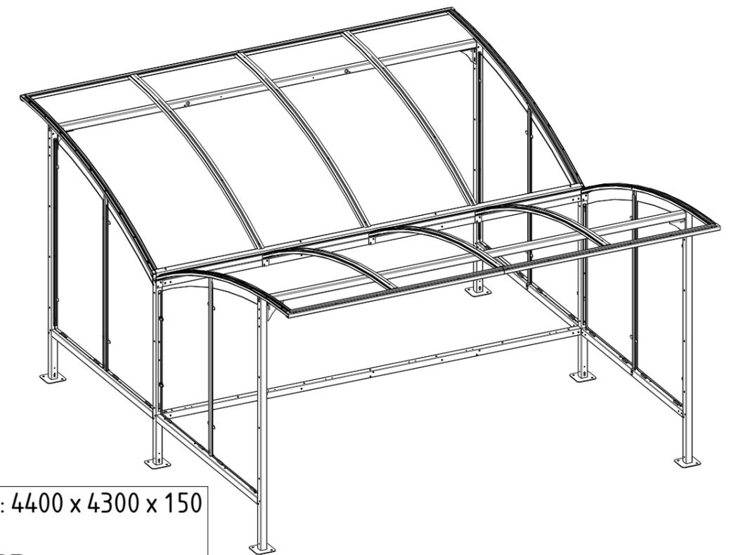
Dimension mini de la dalle béton : 4400 x 4300 x 150
