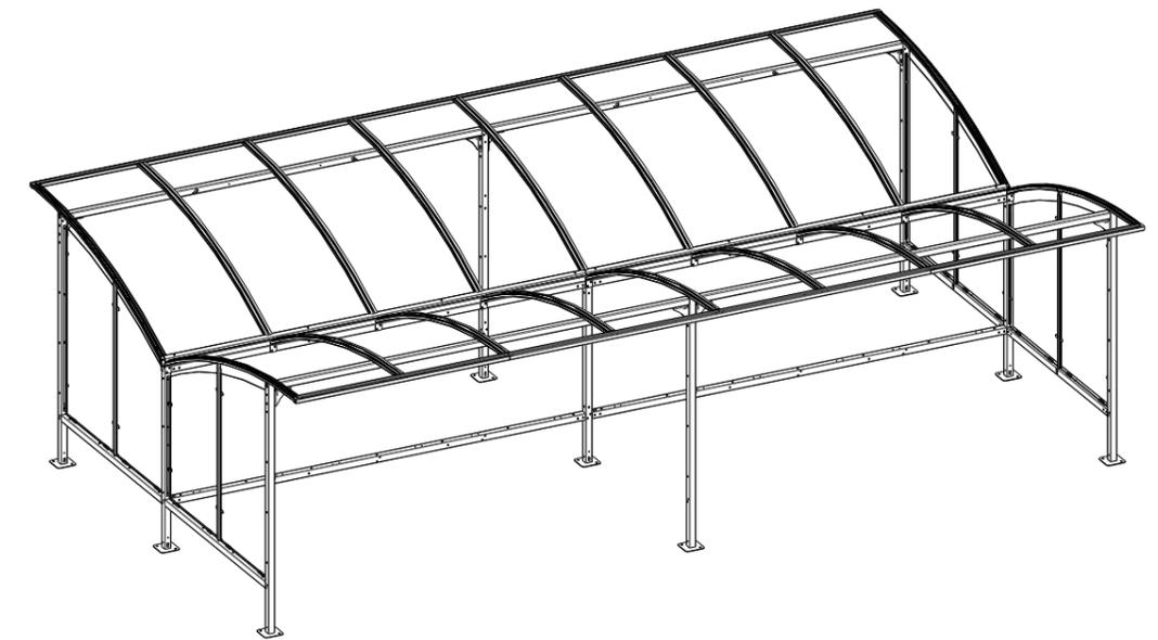
Dimension mini de la dalle béton : 8300 x 4400 x 150
