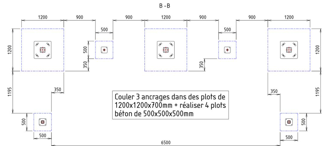
Couler 3 ancrages dans des plots de 1200x1200x700mm + réaliser 4 plots béton de 500x500x500mm
