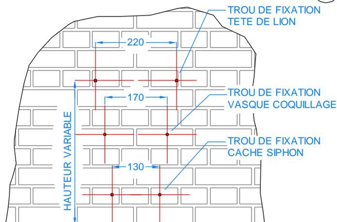
LES TROUS POUR FIXER LE CACHE SIPHON SERONT A CONTRE-PERCRER UNE FOIS LE COQUILLAGE INSTALLE.
